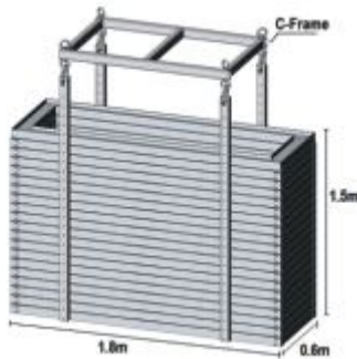
Şekil 1: Eşdeğer şekil değiştirme yapabilecek şekilde imal edilmiş laminer kutu
