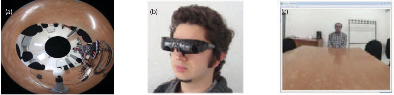
Şekil 2. (a) Tümyönlü video karesi. (b) Hareket sensörü ve video gözlüğü donanımlı kullanıcı. (c) Kullanıcının bakış açısına giren sahnenin işlenmiş görüntüsü.
