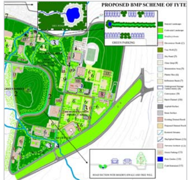
Şekil 1. Öneri Sürdürülebilir Yağmursuyu Yönetim (Yeşil Altyapı Teknikleri) Şeması (Ulusoy, 2011, s.163)
